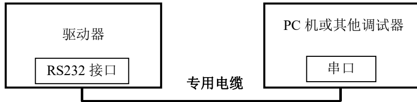
图 6 参数调试接线原理图
